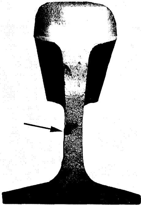
Дефект 76.3/56.3 Излом рельса в эксплуатации от усталостной трещины, возникшей от дефекта сварки в сварном шве в шейке (показанного стрелкой)
