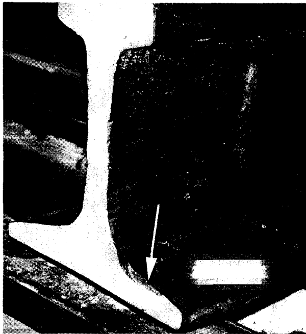
Вид излома после вскрытия дефекта. Стрелкой показан дефект-трещина от раковины в сварном шве
