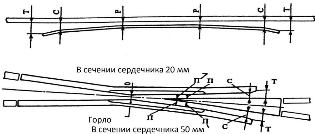
Рисунок 3.12. Места контрольных измерений ширины желобов в остройх крестовинах и в контррельсах
