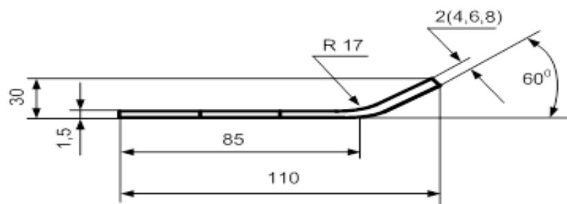
Рисунок 3.11. Специальная прокладка из изолирующего материала для регулировки ширины колеи на стрелочных переводах с железобетонными брусьями
