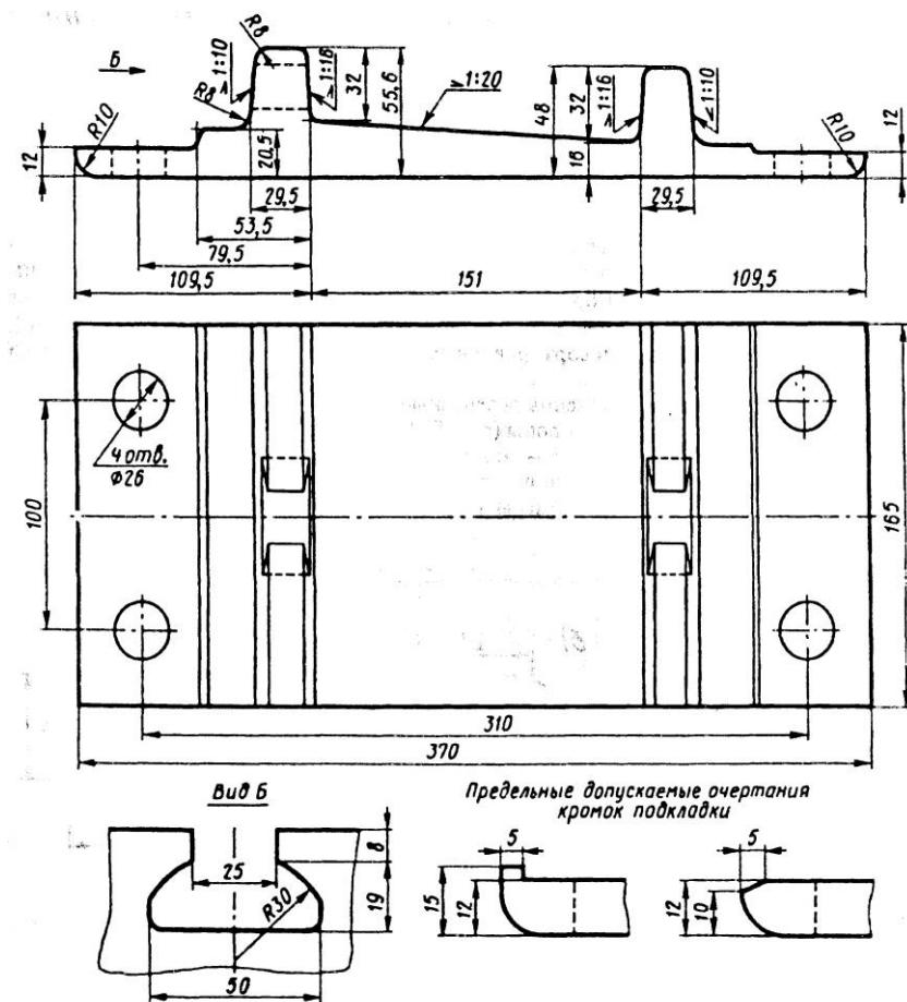
Рисунок П.3.10. Подкладка КД65 раздельного скрепления к рельсам типов Р65 и Р75 (мм)
