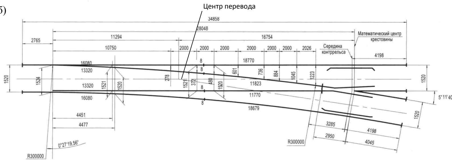
Рисунок П.7.2 – Эпюра укладки (а) и схема разбивки (б) стрелочного перевода типа Р65 марки 1/11 на железобетонных брусьях.
