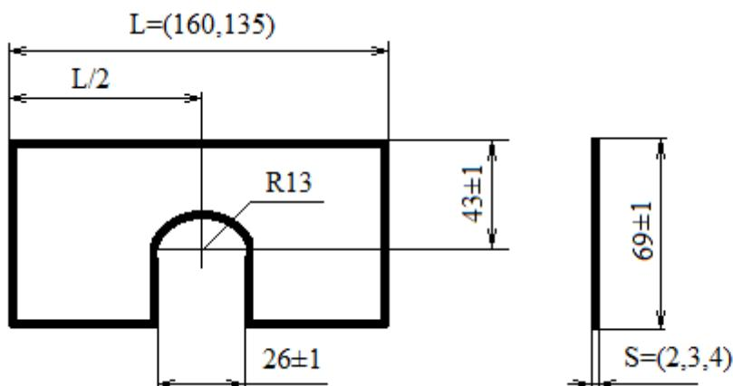
Рисунок 3.15.б Регулировочная металлическая прокладка
