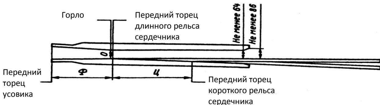
Рисунок 3.13. Места контрольных измерений ширины желобов и расстояний от переднего торца усовика до переднего торца длинного рельса сердечника ( $\Phi$ ) и между торцами длинного и короткого рельса сердечника ( $Л$ ) на крестовинах с подвижным сердечником (мм)
