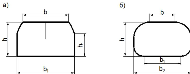
Рисунок П.5.2. Поперечные сечения деревянных переводных брусьев:
