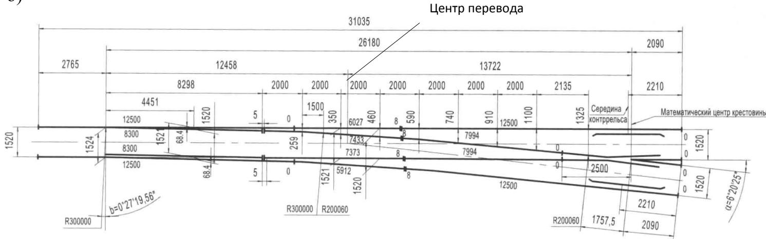
Рисунок П.7.4 – Эпюра укладки (а) и схема разбивки (б) стрелочного перевода типа Р65 марки 1/9 на железобетонных брусьях. Проекты 2769 и 2215 (мм)
