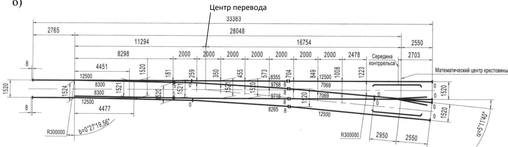
Рисунок П.7.3 – Эпюра укладки (а) и схема разбивки (б) стрелочного перевода типа Р65 марки 1/11 на железобетонных брусьях. Проекты 2768 и 1740 (мм)
