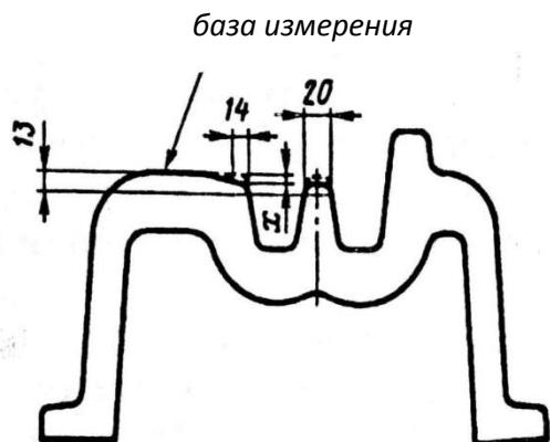
Рисунок 3.19. Измерение вертикального износа  $x$  сердечника (а) и усиков (б) цельнолитой тупой крестовины (мм)
