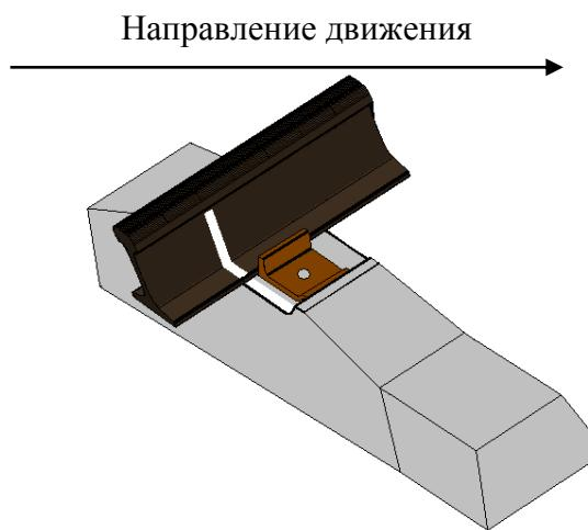
Рисунок 3.33 «Маячная» шпала для контроля угона пути для бесподкладочных скреплений ЖБР-65, ЖБР-65Ш, СМ-1, В-30
