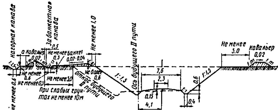
Рисунок П.6.2. Вывемка глубиной до 12 м с шириной основной площадки 7,6 м при поперечном уклоне местности не круче 1:3
