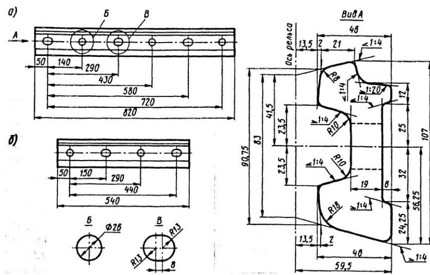
Рисунок П.3.2. Накладка двухголовая к рельсам типа Р50 (мм):
