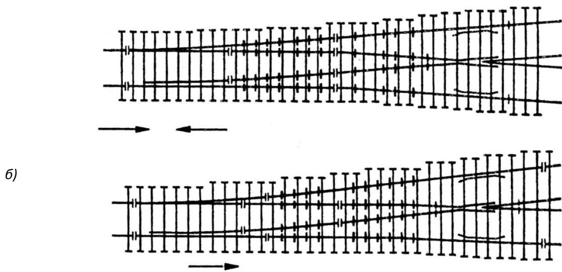
Рисунок 3.29. Схема закрепления от угона симметричного стрелочного перевода марки 1/6 пружинными противоугонами при двухстороннем (а) и одностороннем (б) движении поездов
