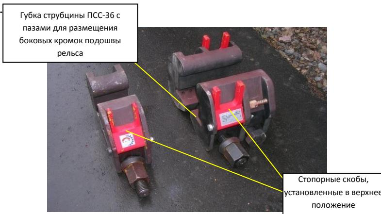
Рисунок 3.36. Одинарная (ширина 70 мм) и двойная (ширина 140 мм) струбцины ПСС-36
