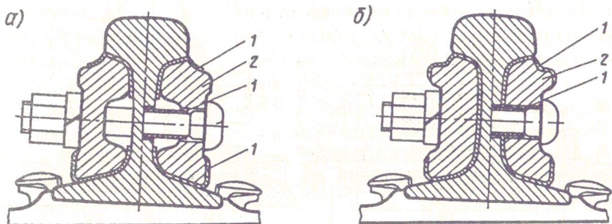
Рисунок 3.44. Клееболтовой изолирующий стык при костыльном скреплении:
