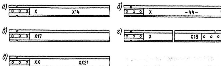
Рисунок 3.5. Маркировка дефектных (*а* — *г*) и остродефектных (*д*) рельсов в зависимости от расположения дефекта: *а* — вне стыка; *б* — по всей длине рельса; *в* — на левом конце рельса; *г* — на правом конце рельса; *д* — вне стыка
