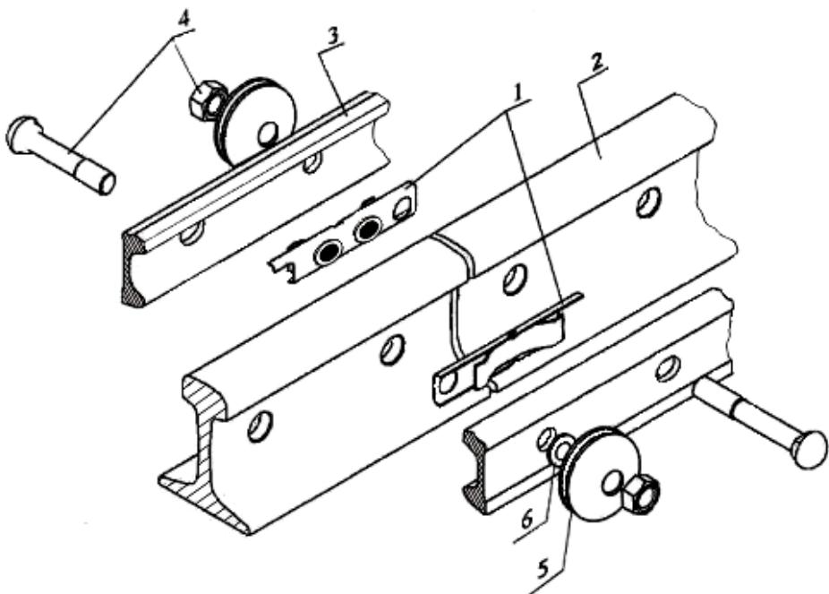
Рисунок 3.40. Схема монтажа рельсового стыкового пружинного соединителя.
