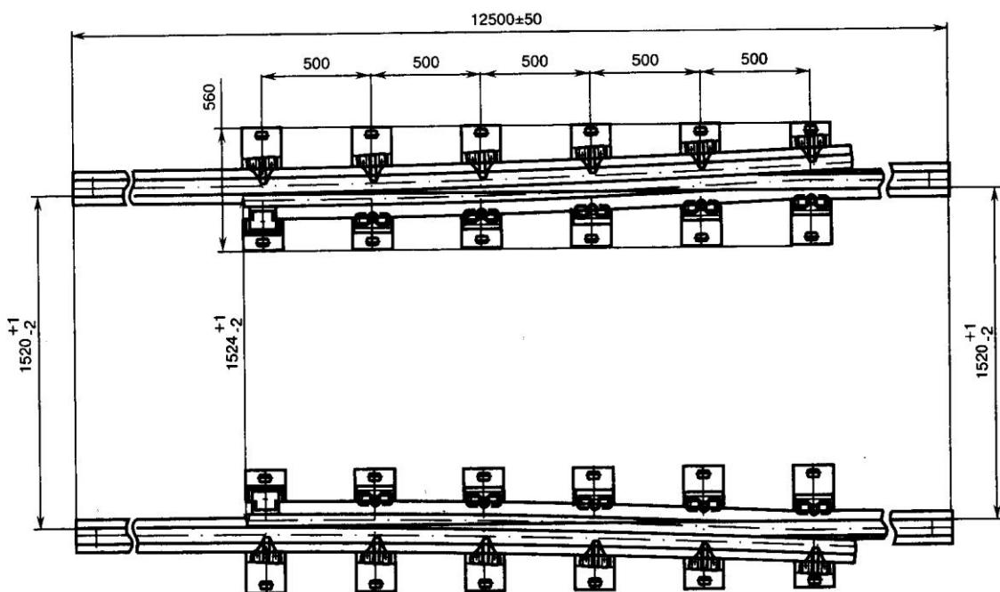
Рисунок 3.30. Схемастыка уравнительного проекта СП 848 (мм)
