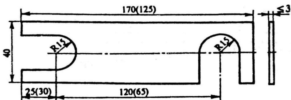
Рисунок 3.15.а Регулировочная металлическая прокладка (мм)
