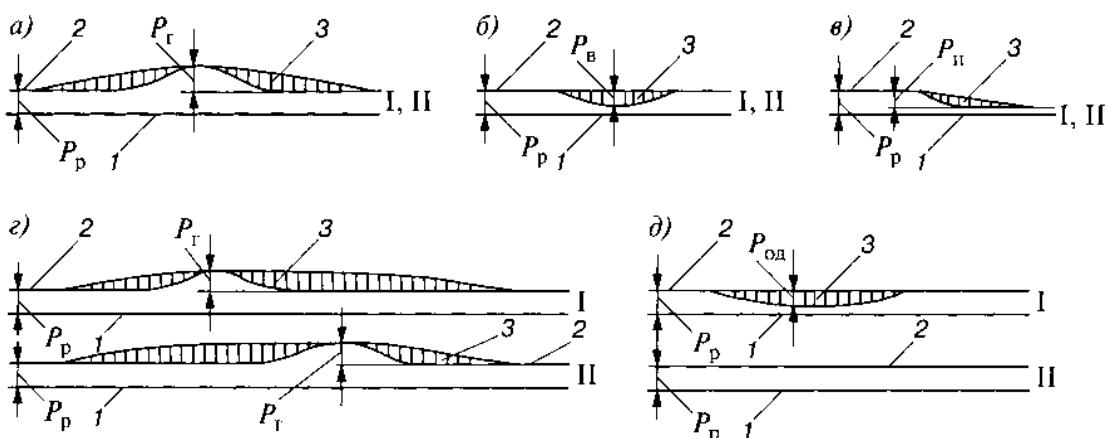
Рисунок 3.47. Разновидность пучин: а) – пучинный горб; б) – пучинная впадина; в) – пучинный перепад; г) – перекосная пучина.
