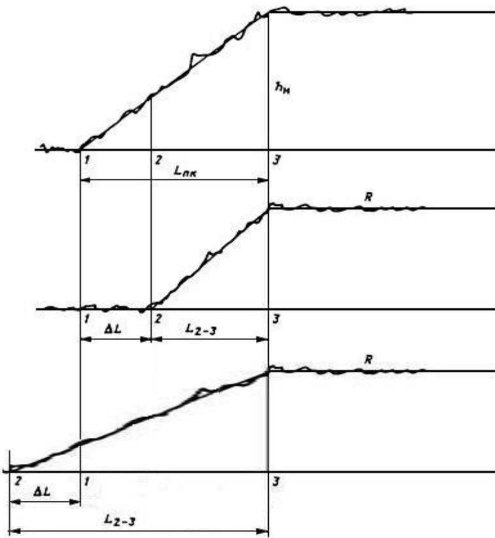
Рисунок 2.1. Пример несовпадения начала возвышения наружного рельса с началом кривизны на ленте путеизмерителя
