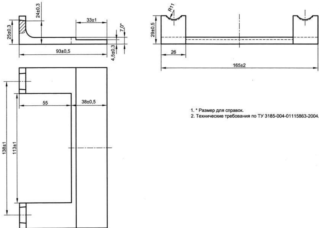
Рисунок 3.35 Под克莱мник APC-4 маячный (мм)
