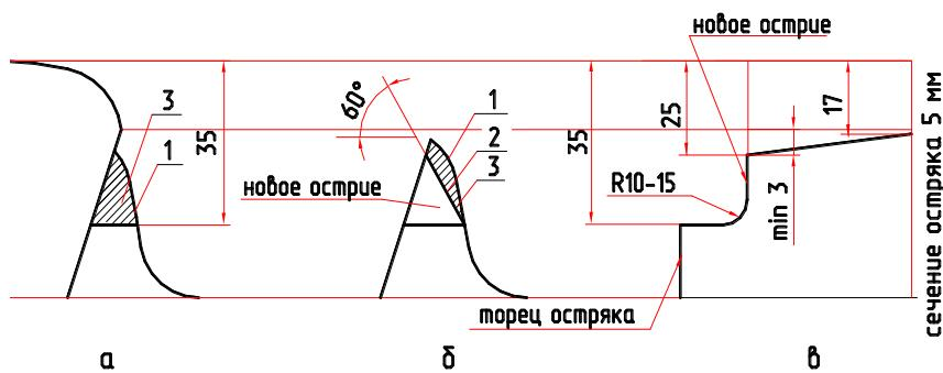
Рисунок 3.24 . Шлифовка головки остряка при переносе острия (мм)
