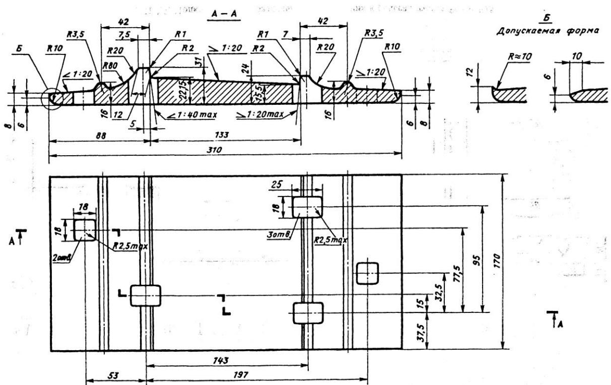
Рисунок П.3.8. Подкладка Д50 костыльного скрепления к рельсам типа Р50 (мм)
