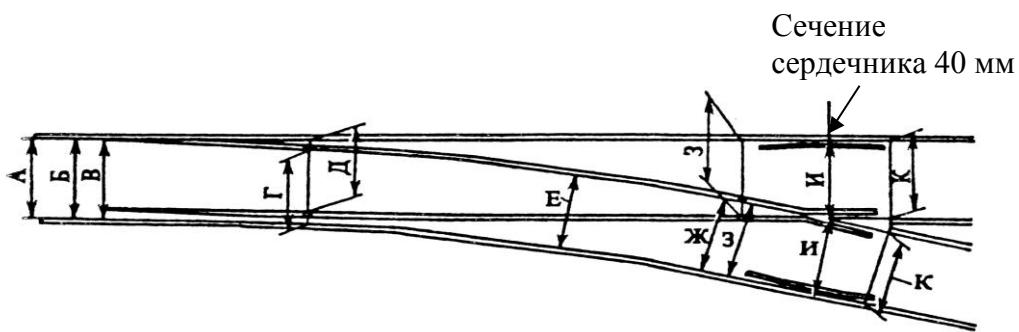
Рисунок 3.7. Места контрольных измерений ширины колеи на обычновенных стрелочных переводах
