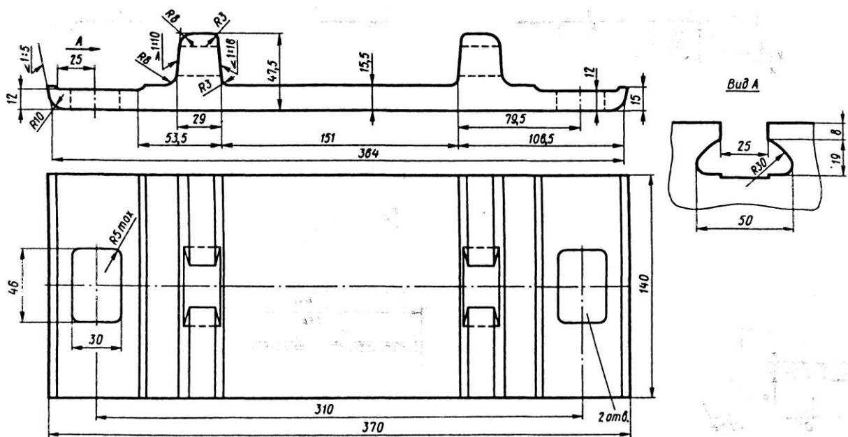
Рисунок П.3.9. Подкладка КБ65 раздельного скрепления к рельсам типов Р65 и Р75 (мм)
