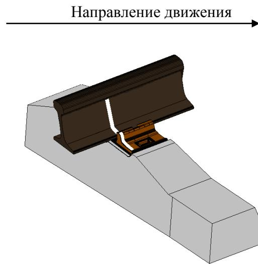
Рисунок 3.32 «Маячная» шпала для контроля угона пути для подкладочных скреплений КБ-65, ЖБР-65ПШМ, ЖБР-65ПШ
