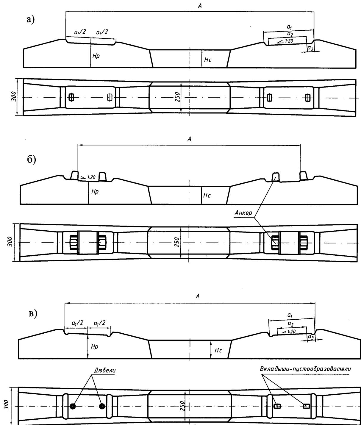
Рисунок П.5.4. Железобетонные шпалы типа а) I, б) II, в) III
