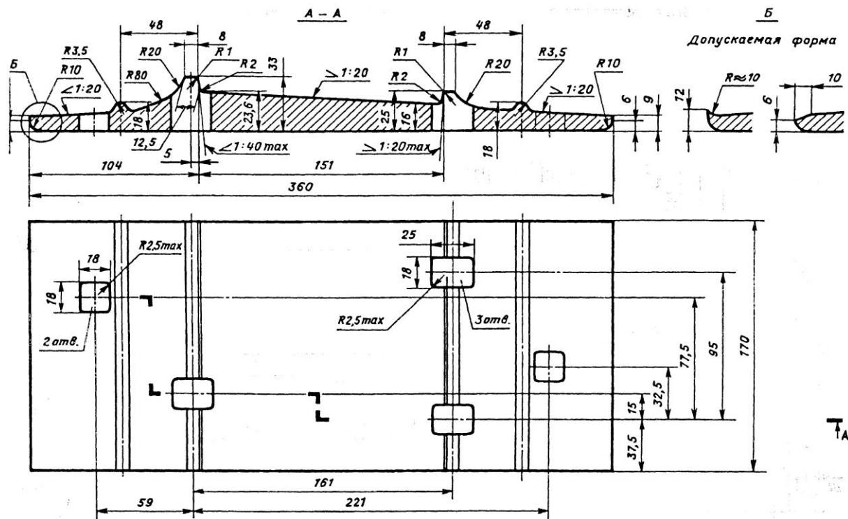
Рисунок П.3.4. Подкладка Д65 костыльного скрепления к рельсам типов Р65 и Р75 (мм)
