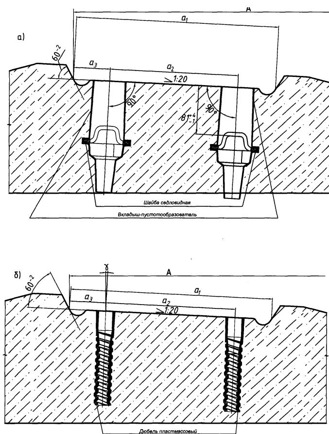
Рисунок П.5.6. Подрельсовая часть шпал типа III: а) для болтового прикрепления, б) для шурупно-дюбельного прикрепления
