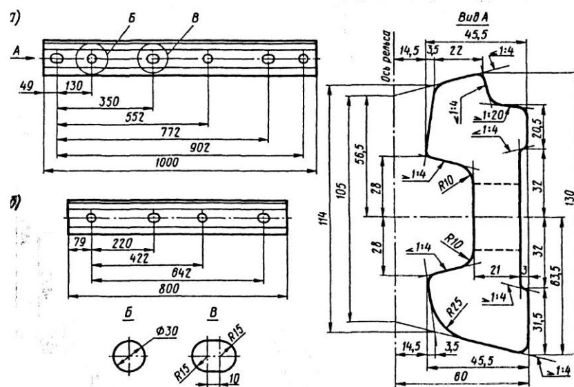
Рисунок П.3.1. Накладка двухголовая к рельсам типов Р65 и Р75 (мм):
