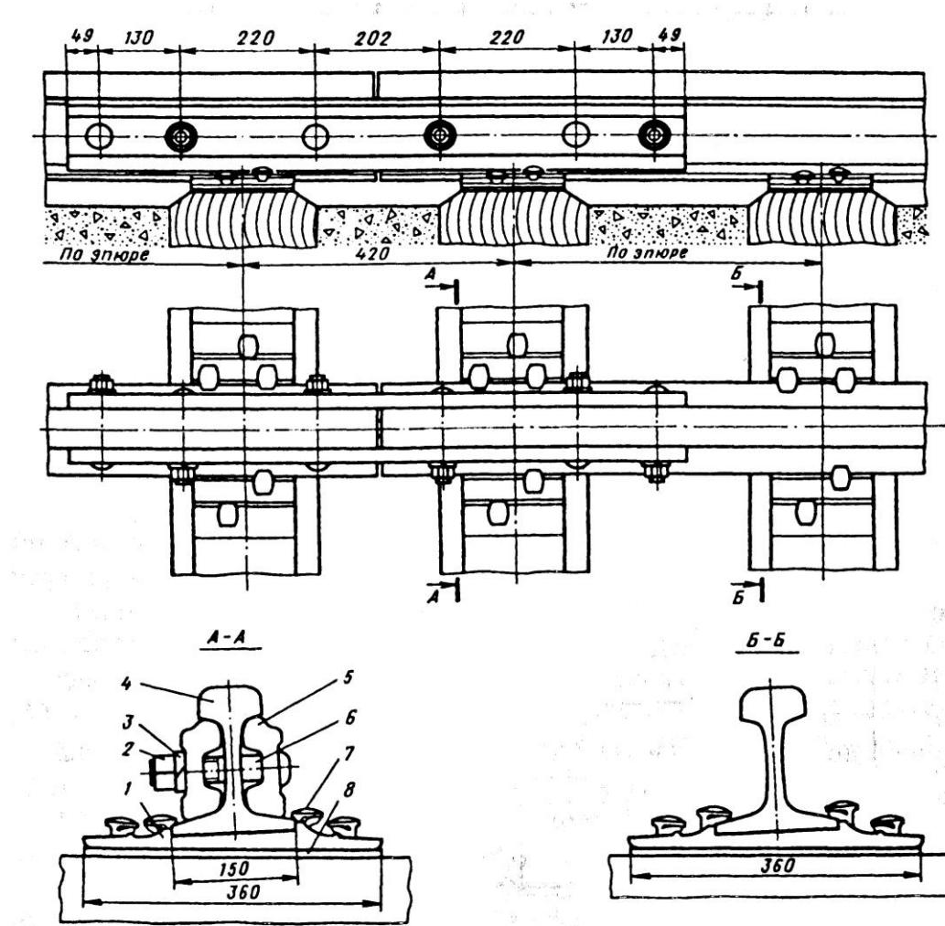
Рисунок 3.1. Стыковое и промежуточное костыльное скрепление при рельсах Р65, Р75 (мм)
