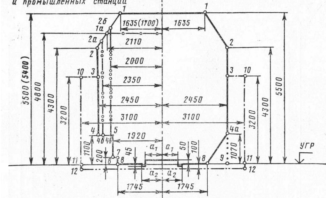
Рисунок П.1.2. Габарит приближения строений С<sub>п</sub> (мм)
