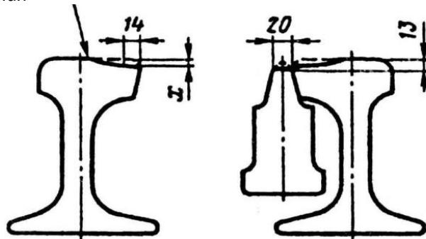
Рисунок 3.22. Измерение вертикального износа  $x$  усовиков острой крестовины с подвижным (поворотным)сердечником (мм)
