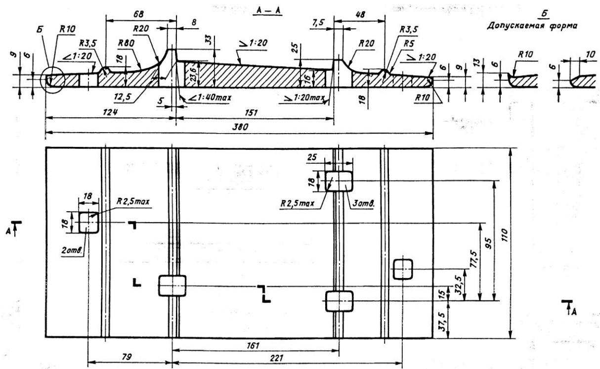
Рисунок П.3.5. Подкладка ДН65 костыльного скрепления к рельсам типов Р65 и Р75 (мм)
