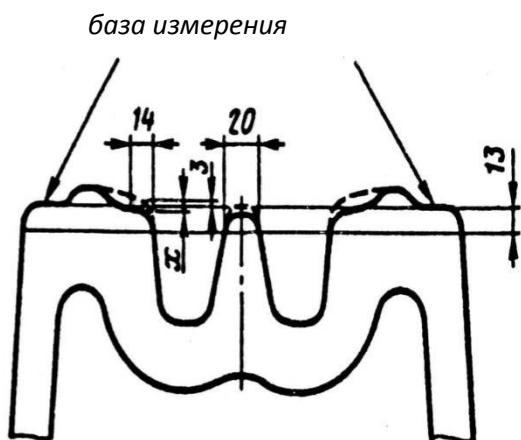
Рисунок 3.20. Измерение вертикального износа  $x$  усовиков сборной (а) и цельнолитой (б) остройх крестовин (мм)
