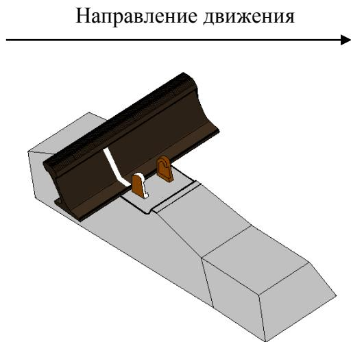
Рисунок 3.34 «Маячная» шпала для контроля угона пути для анкерных скреплений
