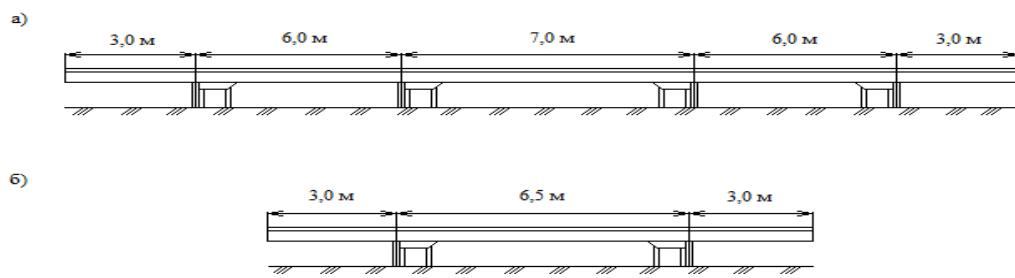
Рисунок 5.1. Стеллаж для хранения рельсов покилометрового запаса: а - для рельсов длинной 25,00 м, б - для рельсов длиной 12,50 м.
