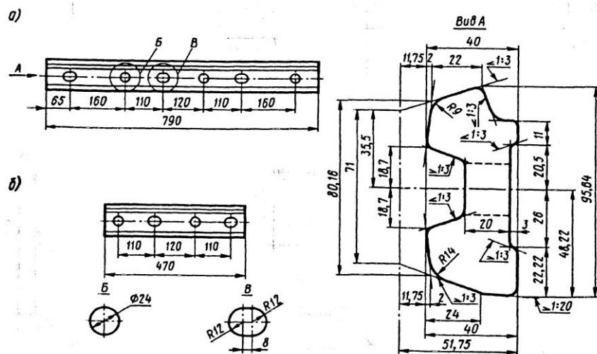
Рисунок П.3.3. Накладка двухголовая к рельсам типа Р43 (мм):
