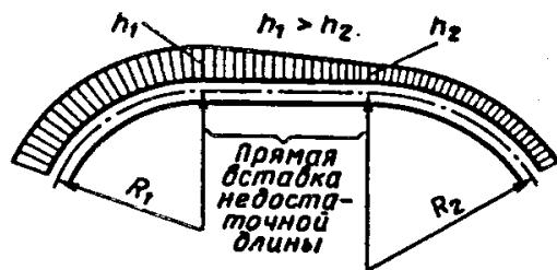
б) при сопряжении смежных кривых одного направления при недостаточной длине прямой вставки
