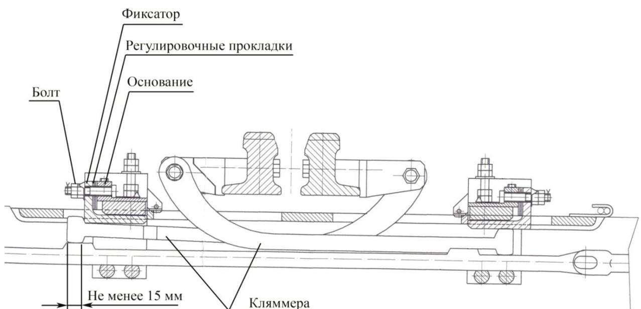
Рисунок 3.17. Регулировка плотности прижатия сердечника к усаживу крестовины:
