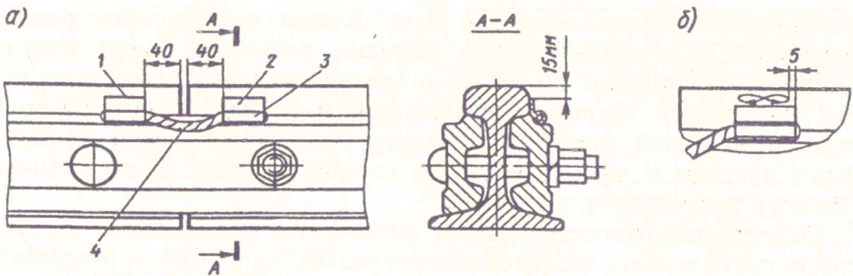
Рисунок 3.38. Схема установки (а) и приварки (б) медного соединителя фартучного типа к головке рельса (мм):
