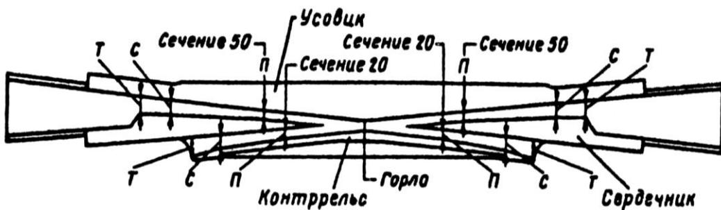
Рисунок 3.14. Места контрольных измерений ширины желобов в тупых крестовинах (мм)
