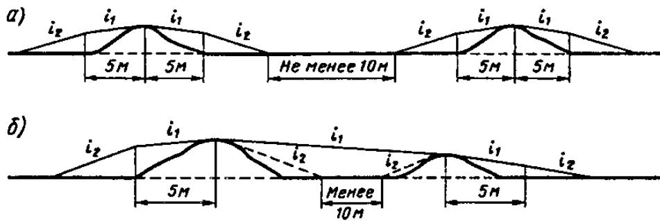
Рисунок 3.49. Схемы устройства отводов от рядом расположенных пучинных горбов при расстояниях между концами отводов: *a* – не менее 10 м; *б* – менее 10 м
