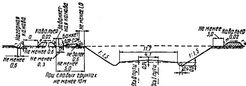
Рисунок П.6.4. Вывемка глубиной до 12 м с шириной основной площадки 11,7 м при поперечном уклоне местности не круче 1:3
