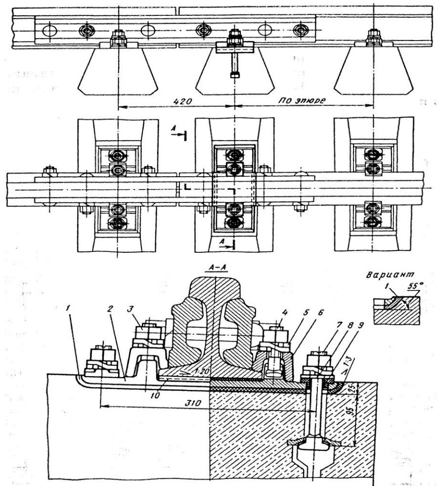
Рисунок 3.2. Стыковое и промежуточное скрепление КБ65 на железобетонных шпалах с рельсами Р65 и Р75 (мм):
