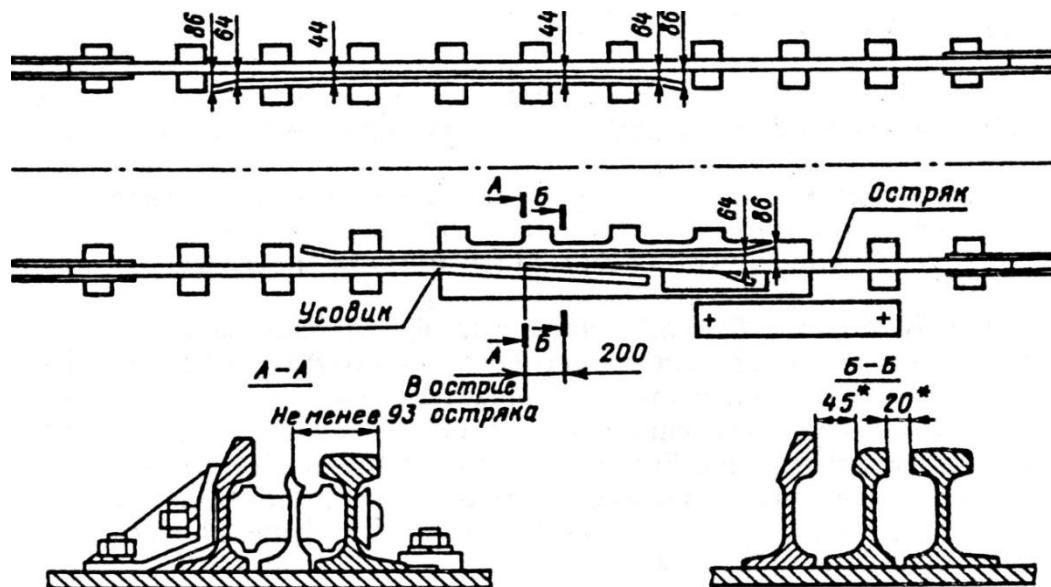
Рисунок 3.31. Башмакосбрасыватели типов Р50, Р65 колеи 1520мм:
