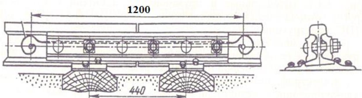
Рисунок 3.39. Рельсовый стык со штепсельным соединителем (мм)
