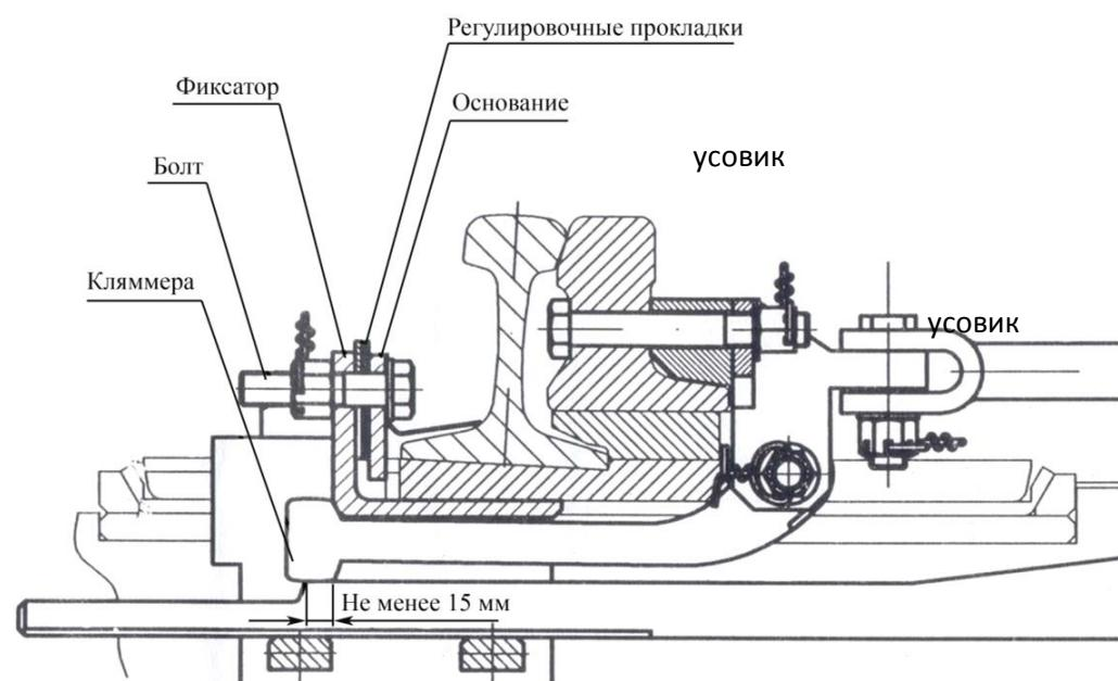
Рисунок 3.16. Регулировка плотности прижатия остряка к рамному рельсу:
