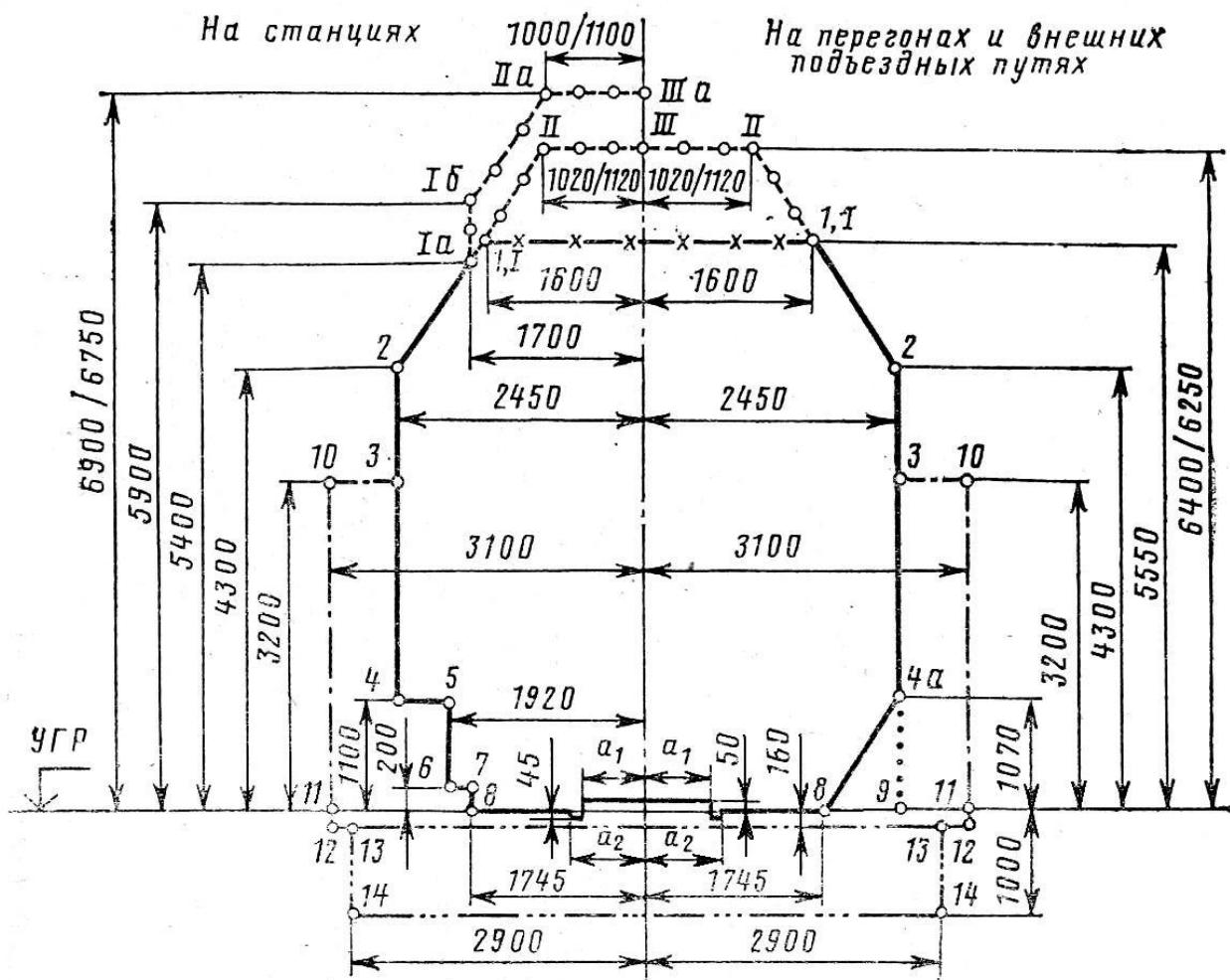
Рисунок П.1.1. Габарит приближения строений С (мм)
