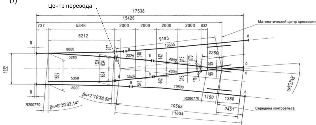
Рисунок П.7.5 – Эпюра укладки (а) и схема разбивки (б) симметричного стрелочного перевода типа Р65 марки 1/6 на железобетонных брусьях для горочных путей. Проект 2628 (мм)
