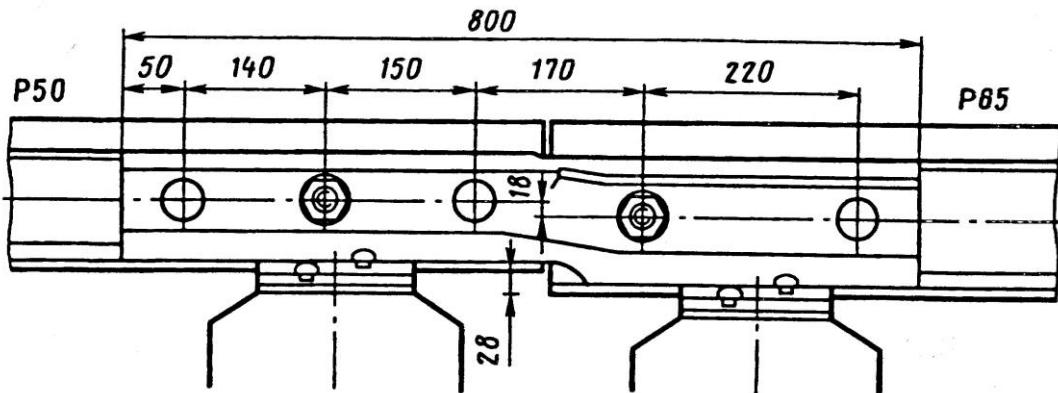
Рисунок 3.4. Переходной стык Р65/Р50 (мм)
