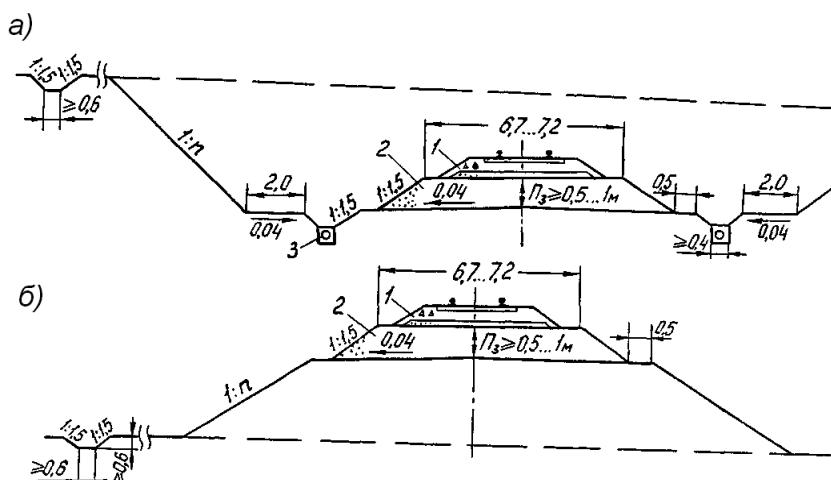
1 - двухслойная балластная призма; 2 - защитный слой из дренирующего грунта; 3 - подковетный дренаж
