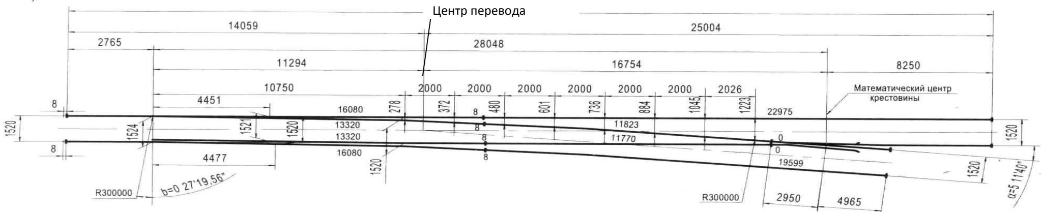
Рисунок П.7.1 – Эпюра укладки (а) и схема разбивки (б) стрелочного перевода типа Р65 марки 1/11 на железобетонных брусьях для скоростного движения. Проект 2726 (мм)
