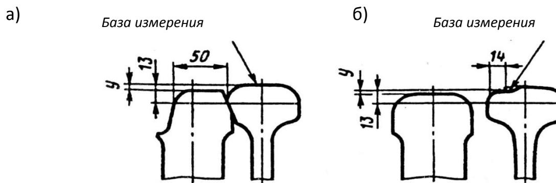
Рисунок 3.27. Измерение понижения остряка относительно рамного рельса у при равномерном (а) и неравномерном (б) вертикальном износе рамного рельса (мм)
