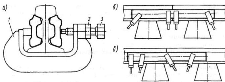
1 – струбцина; 2 – гайка М27; 3 – болт М27
